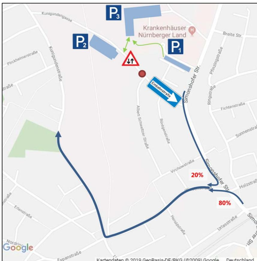
Abbildung 28: Szenario 3a, Übersicht und Verlagerungsverkehr durch Einbahnstraßenregelung
