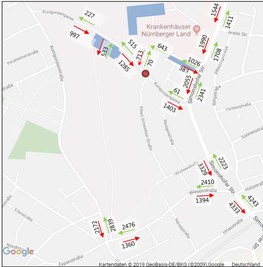
Abbildung 32: Szenario 3a, Resultierender Gesamtverkehr mit Krankenhaus [Kfz/12h]
