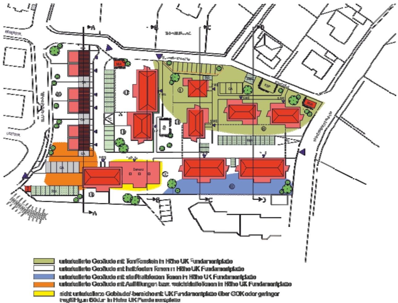
Bild 4: Sehr grobe Darstellung der Untergrundverhältnisse in UK Fundamentplatte
