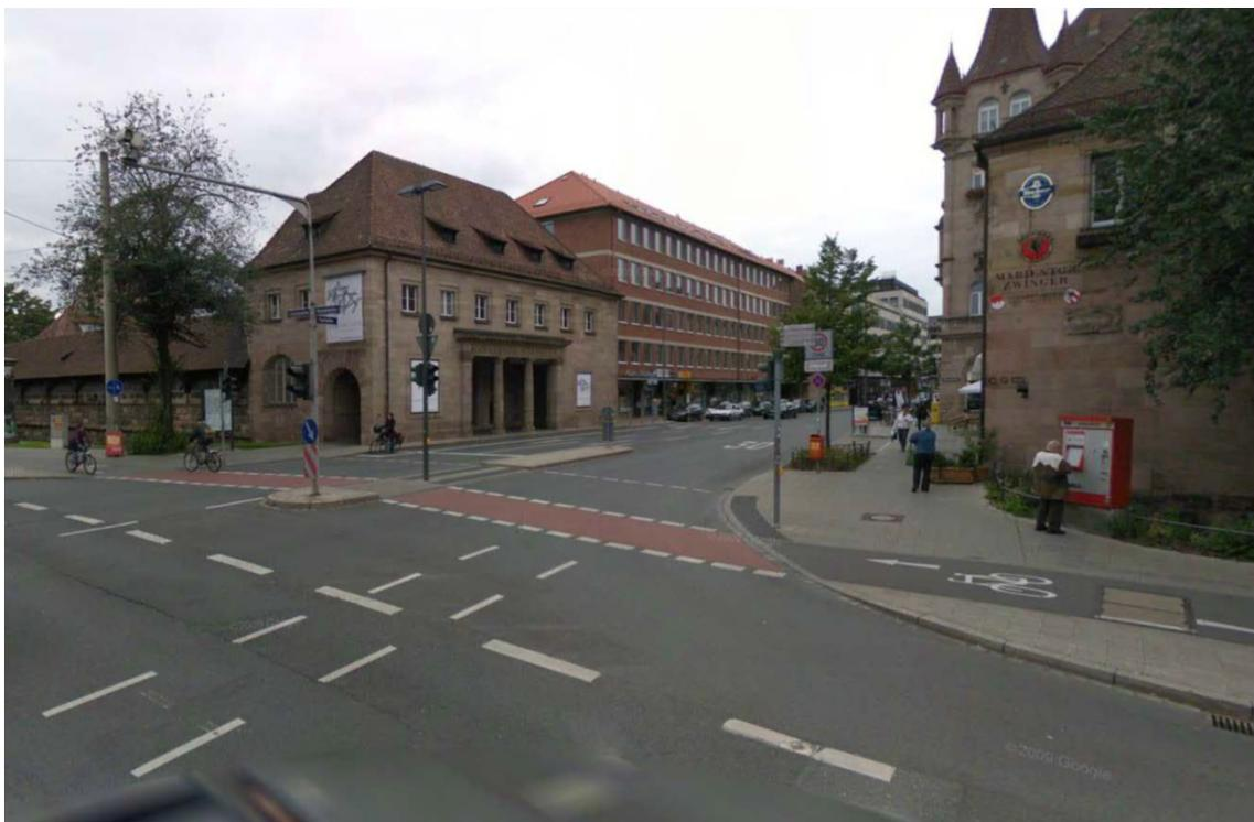
Abbildung 15: Beispiel Absenkung Rad- und Fußweg und Roteinfärbung der Radwegequerung
