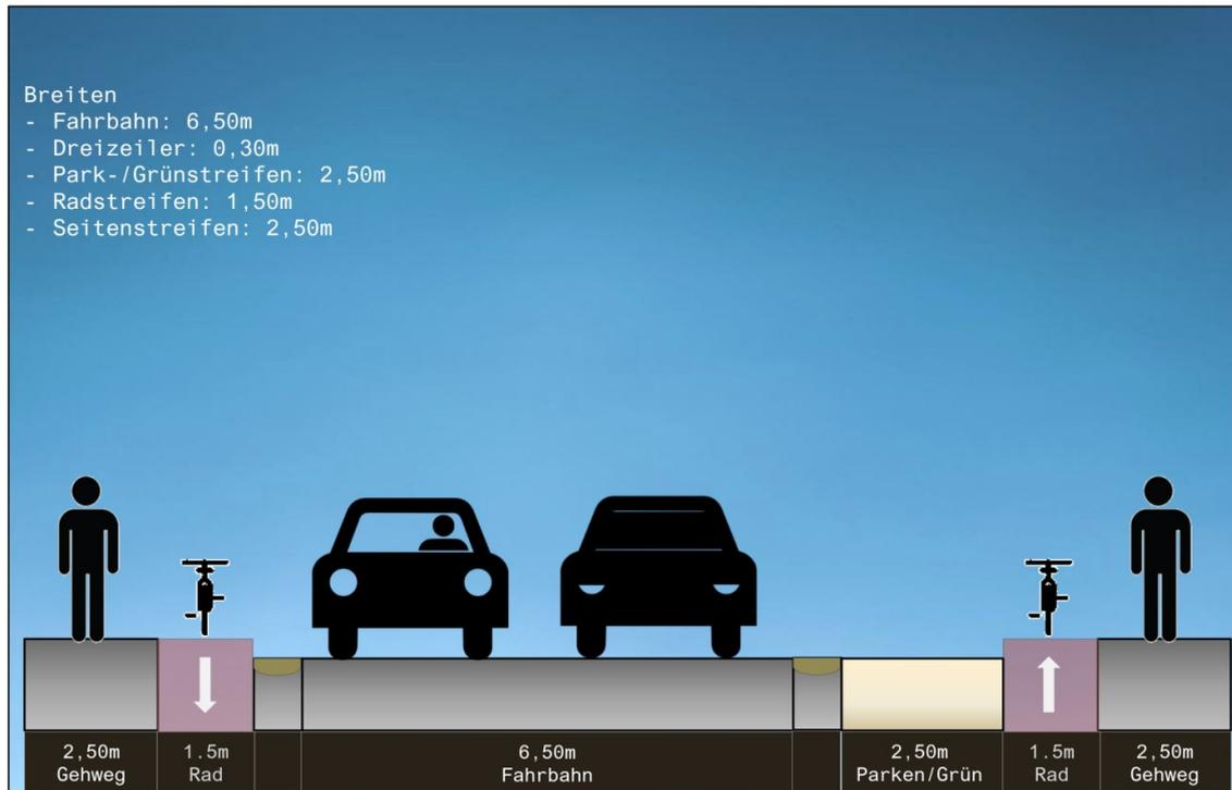
Abbildung 16: Querschnitt Hauptverkehrsstraße
